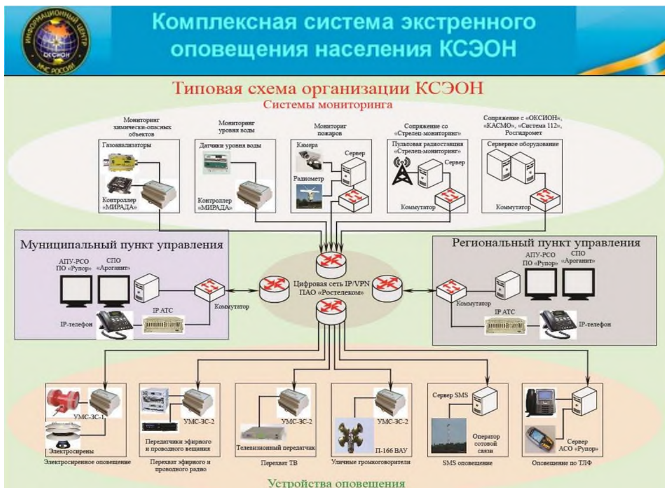
Рис. 14. Схема комплексной системы экстренного оповещения населения (КСЭОН) о техногенных катастрофах, например на атомных и химических объектах.
