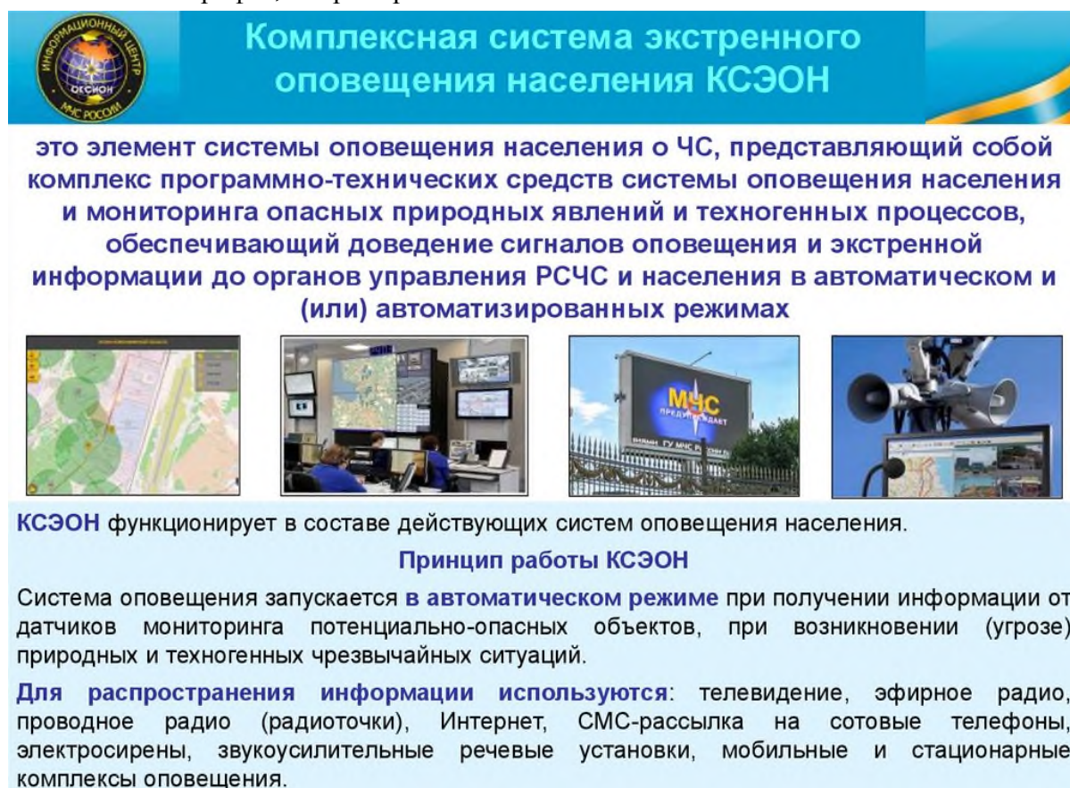
Рис. 15. КСЭОН – элемент системы оповещения, представляющий собой программно-технический комплекс оповещения населения.
